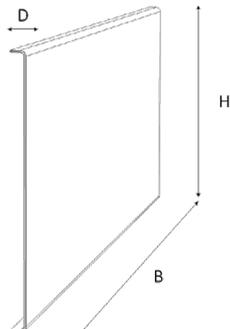
Parlok bietet Ihnen eine Vielzahl von Abdeckplatten, die alle zur Verbesserung der Aerodynamik des Fahrzeugs beitragen und somit zu Kraftstoffeinsparungen sowie zur Reduzierung der CO<sub>2</sub>-Emissionen führen.
