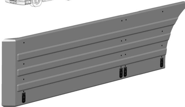
Die Funktion der Parlok Aero Abdeckplatten für Seitenschutzsystem besteht darin, die Turbulenzen unter und hinten dem Anhänger zu verringern, indem der Luftstrom wirtschaftlicher vorbei am Anhänger geleitet wird. Laut CFD-Simulationen und Raupentests werden durch Parlok Seitenschutz um bis zu 13% weniger Luftwiderstand und über 5% weniger Kraftstoffverbrauch erreicht, im Vergleich zu einer Kombination aus Schlepper mit Standard-Sattelauflegern.
